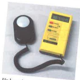
Un luxmètre, utilisé par les photographes en particulier : capteur permettant de mesurer l'éclairement ; cette mesure s'exprime dans une unité appelée « lux », et non en candela.
