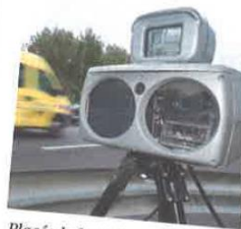
Placés le long des routes et des autoroutes et utilisés par la police, les radars tachymètres permettent de mesurer la vitesse des véhicules avec une marge d'erreur de \pm 3\% .
